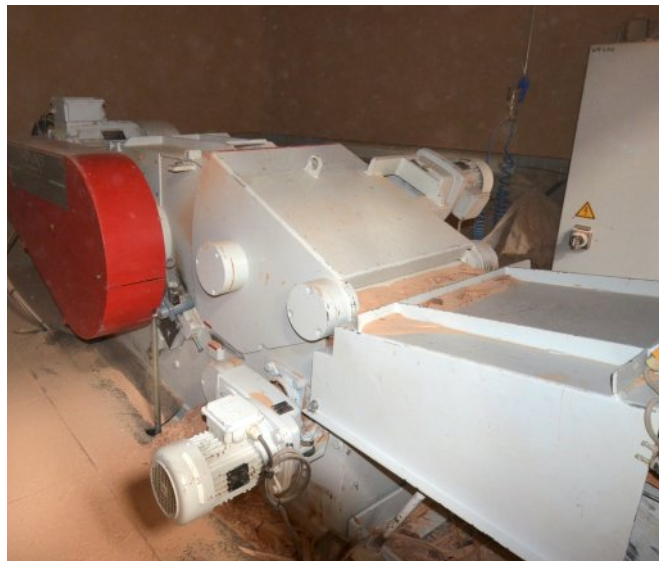
Broyeur de chutes Haas en amont de la ligne de briquetage chez Manubois, photo FD
